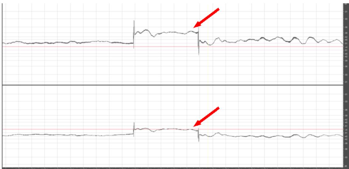
Figura 14 - Variação do nível DC provocada por saturação do dispositivo de captação.
