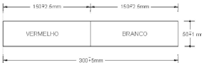
nota: No caso de utilização de base metálica o retrorefletor deverá ser selado pelo metal dobrado ao longo das bordas horizontais, e a largura visível do retrorefletor deverá ser de 45 + - 2,5mm.
