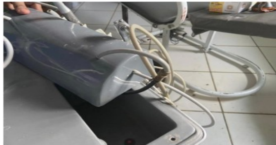
Compressor com mangueiras estouradas e danificadas por falta de manutenção adequada.
