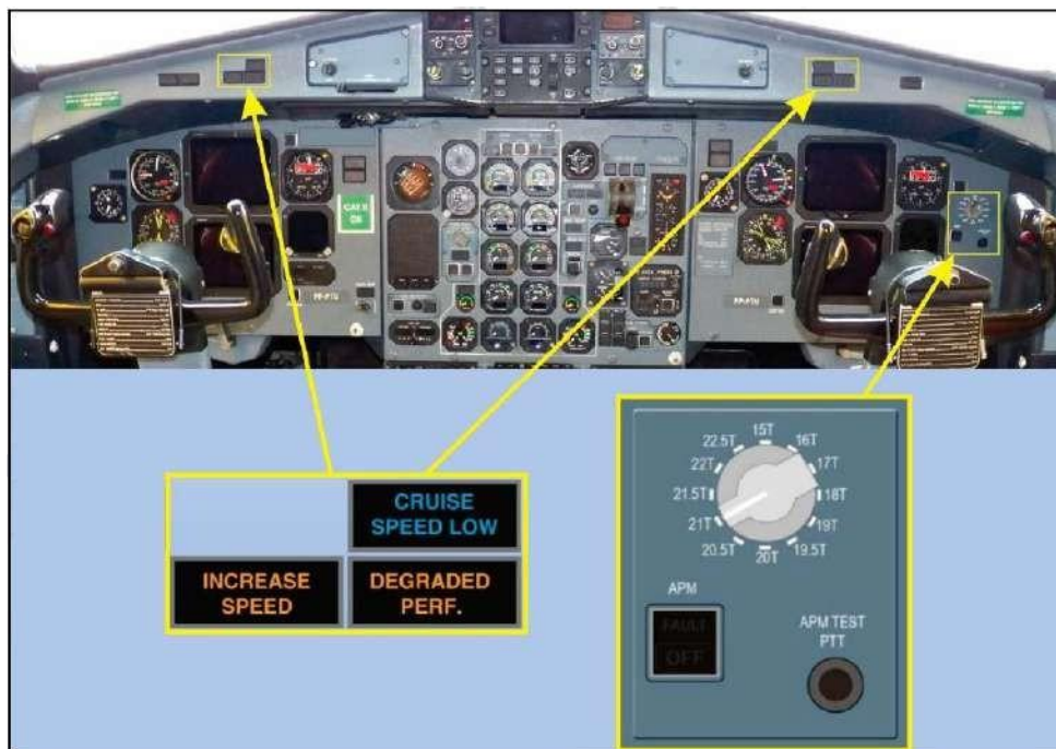
Figura 12 - Posição dos componentes de interface Homem-Máquina do APM.
