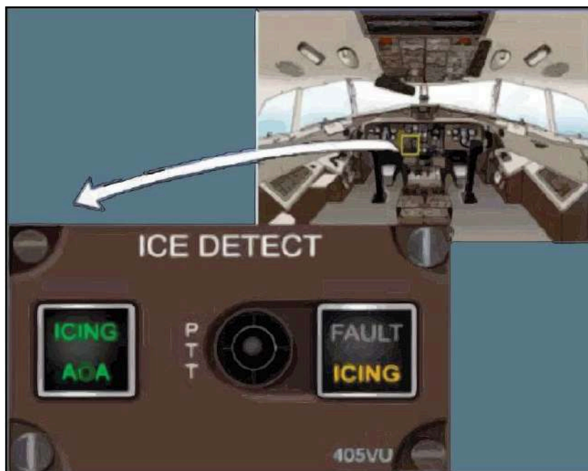
Figura 8 - Indicação do painel ICE DETECT com a luz âmbar ICING acesa, indicando condição de gelo. Fonte: ATR Training Centre.
