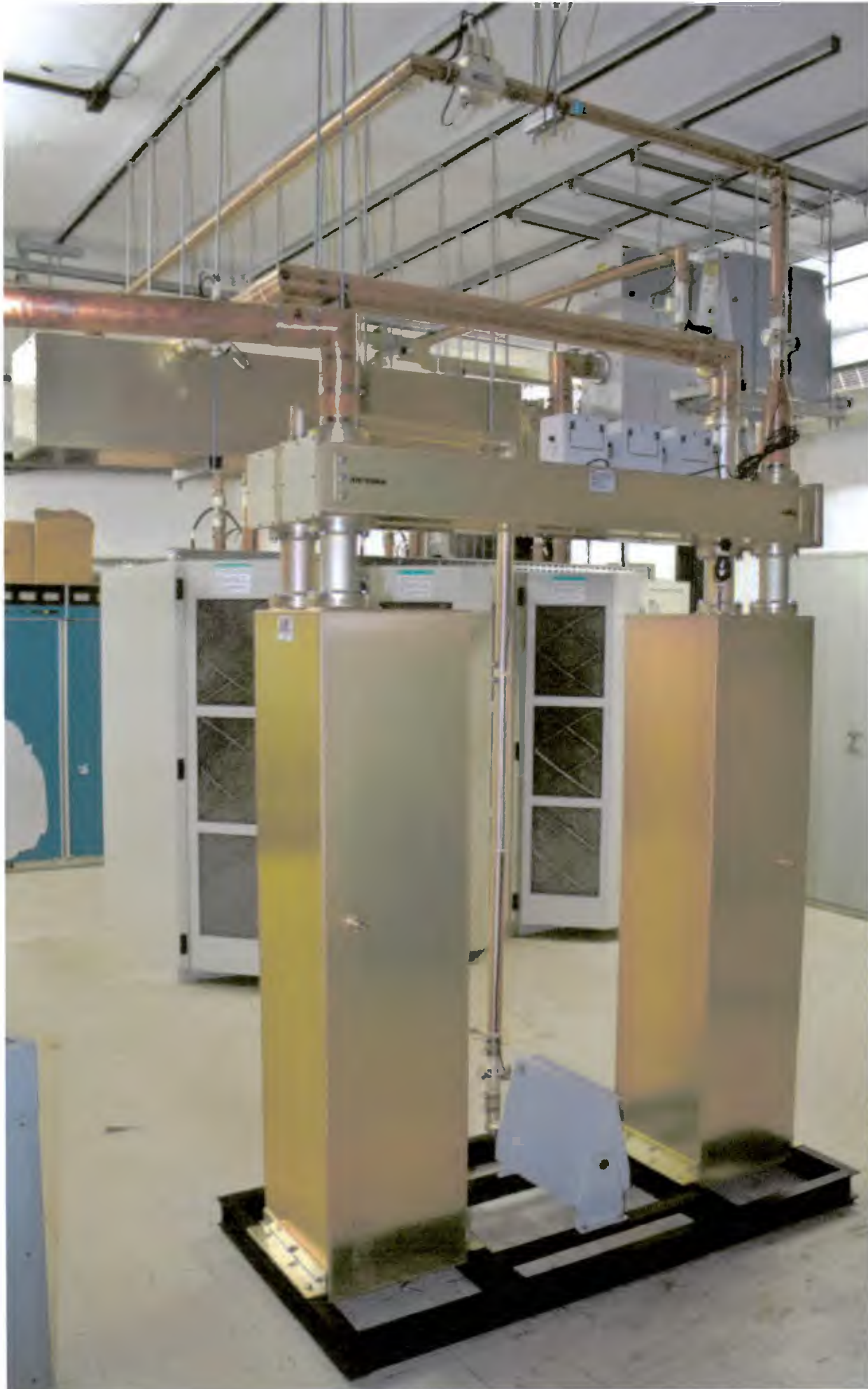
Foto 4 - Vista da Parte Traseira do Equipamento mostrando as interligações das diversas unidades, a Saída de R.F. e as cargas de rejeição.
