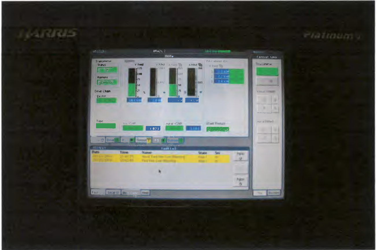
Foto 2 – Vista da Unidade de Monitoração e Controle de Combinação dos Amplificadores em Paralelo
