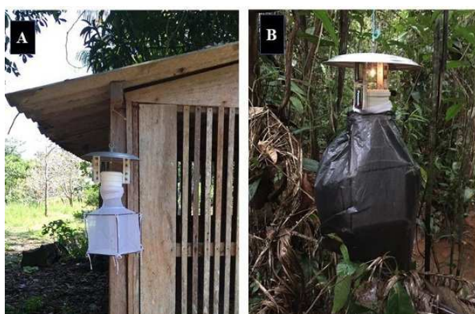
Figura 5 - Armadilha luminosa do tipo CDC. A. CDC instalada no galinheiro; B. CDC com saco plástico para proteção da chuva. Créditos da imagem: Acervo LTDA.
