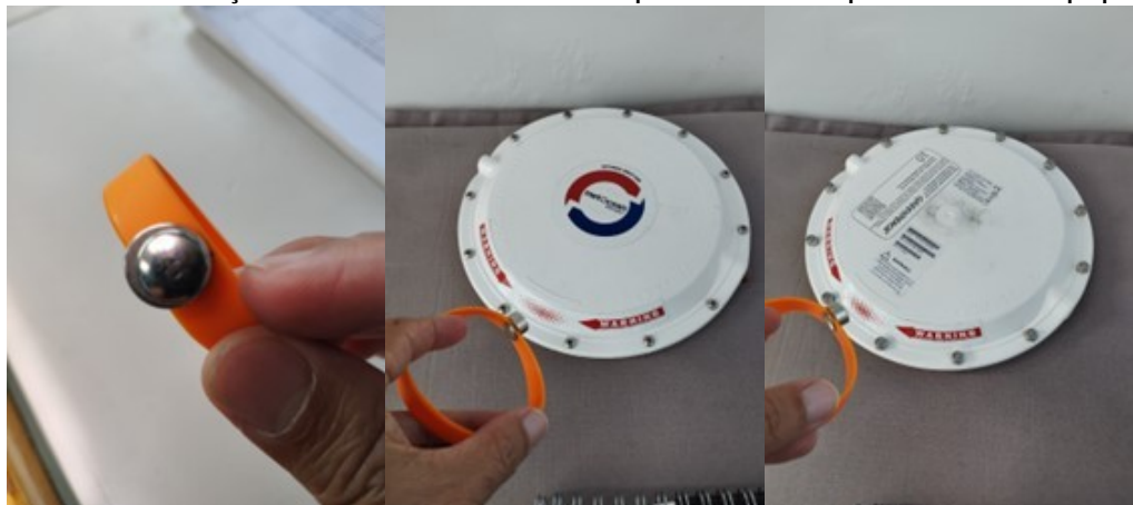
Figura 2 – imã de ativação do derivador Stokes e o procedimento para ativar o equipamento.
