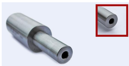
Figura 5 – Cano de prova/provete calibre 9mm Luger
