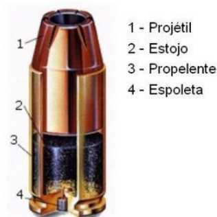
Figura 3 – Munição para armas de alma raiada e suas partes
