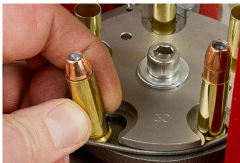
Figura 21 - Recarga de projétil utilizando prensas e matrizes (dies)
