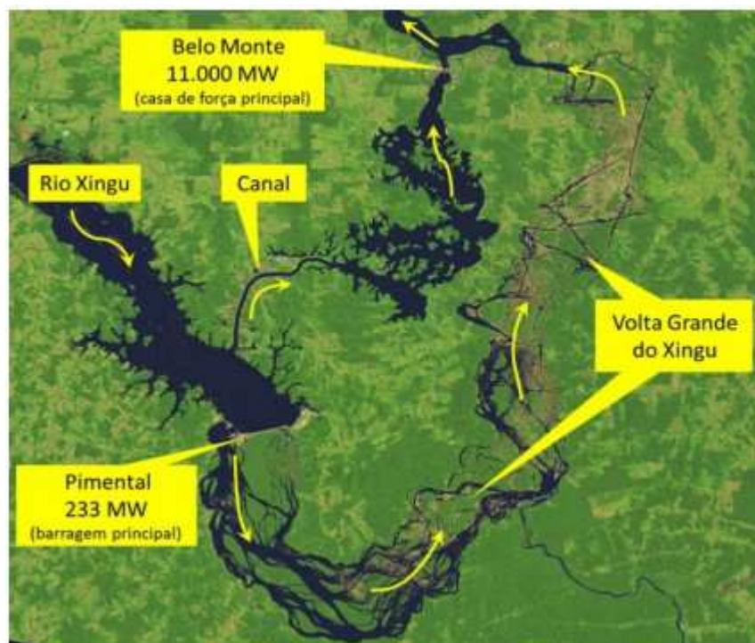
Figura 1: Arranjo esquemático das estruturas da UHE Belo Monte e Volta Grande do Xingu (Trecho de Vazão Reduzida - TVR).
