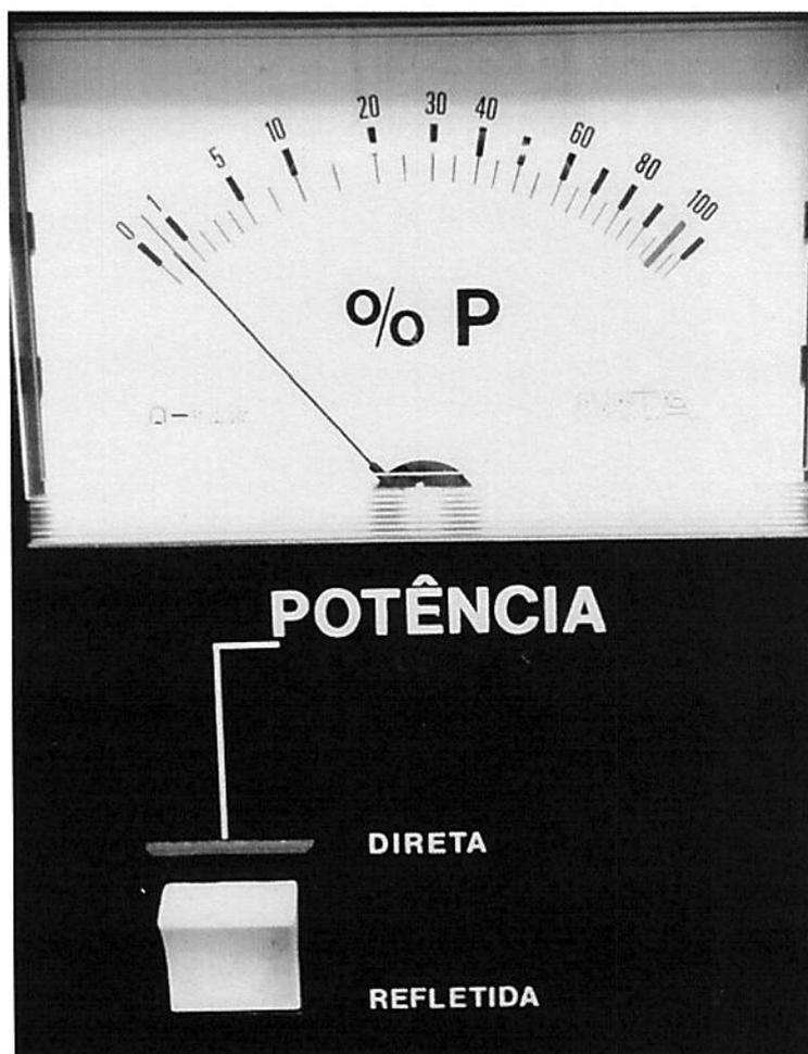
Figura 18 - Medidor de Potência de Saída Refletida
