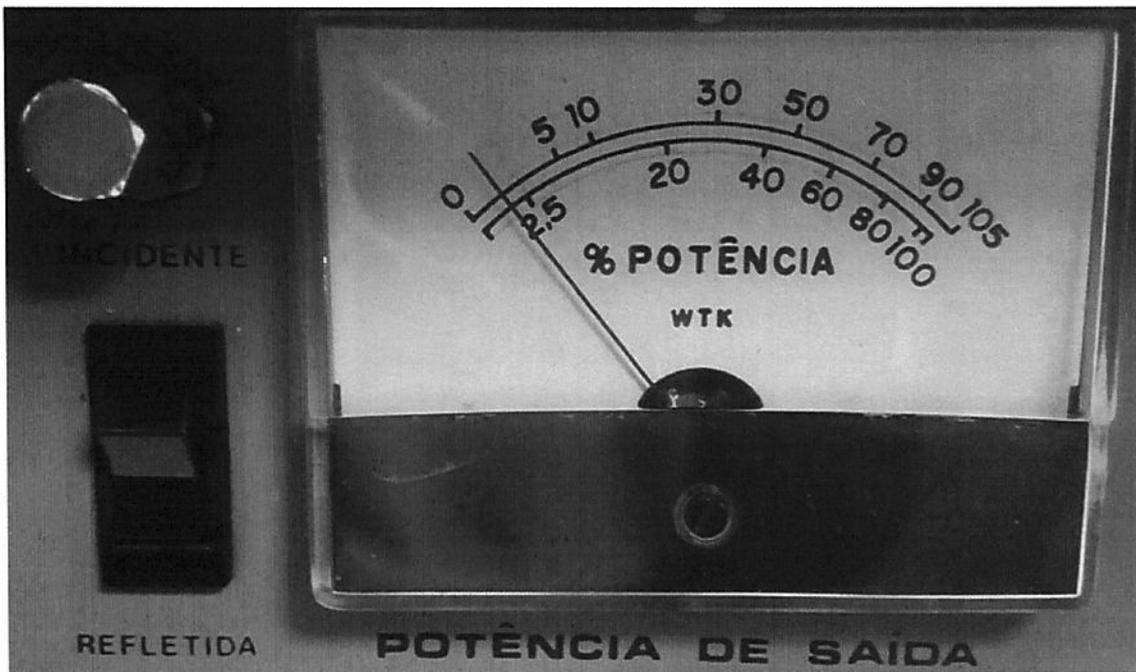
Figura 18 - Medidor de Potência de Saída Refletida
