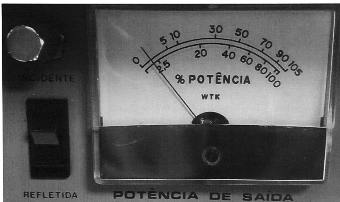
Figura 18 - Medidor de Potência de Saída Refletida
