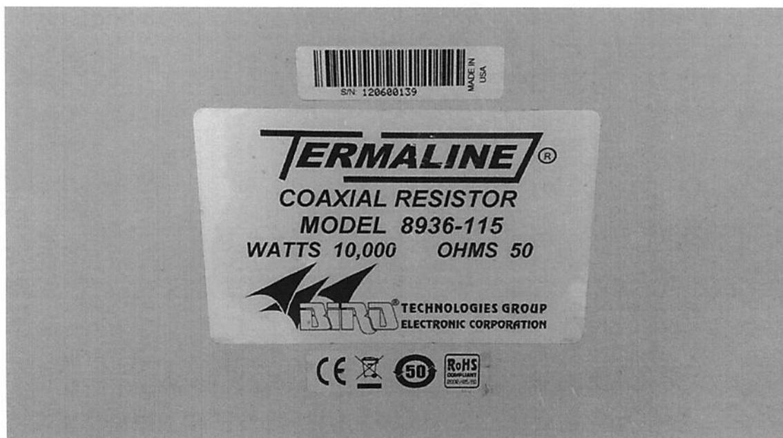
Figura 2 - Placa de Identificação da carga artificial utilizada no ensaio
