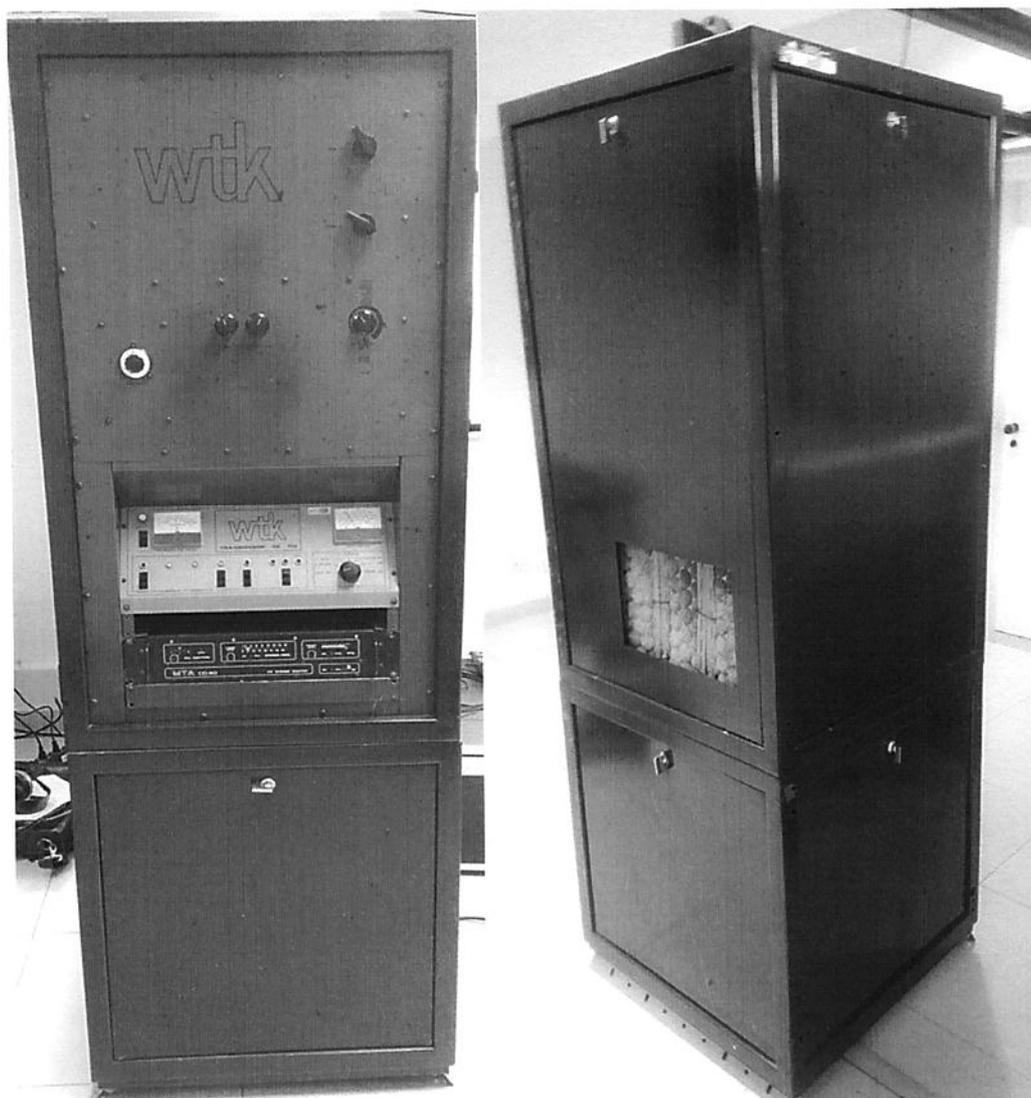
Figura 8 - Rack Transmissor vista frontal e traseira
