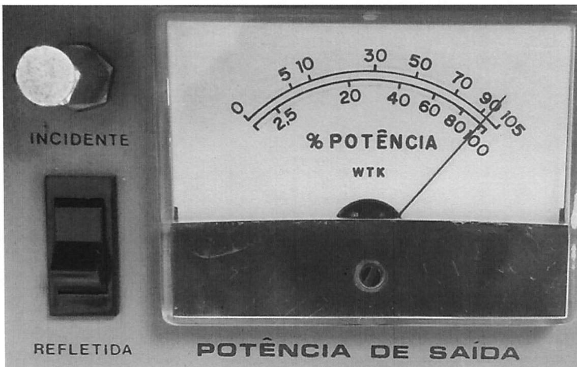
Figura 17 - Medidor de Potência de Saída Incidente
