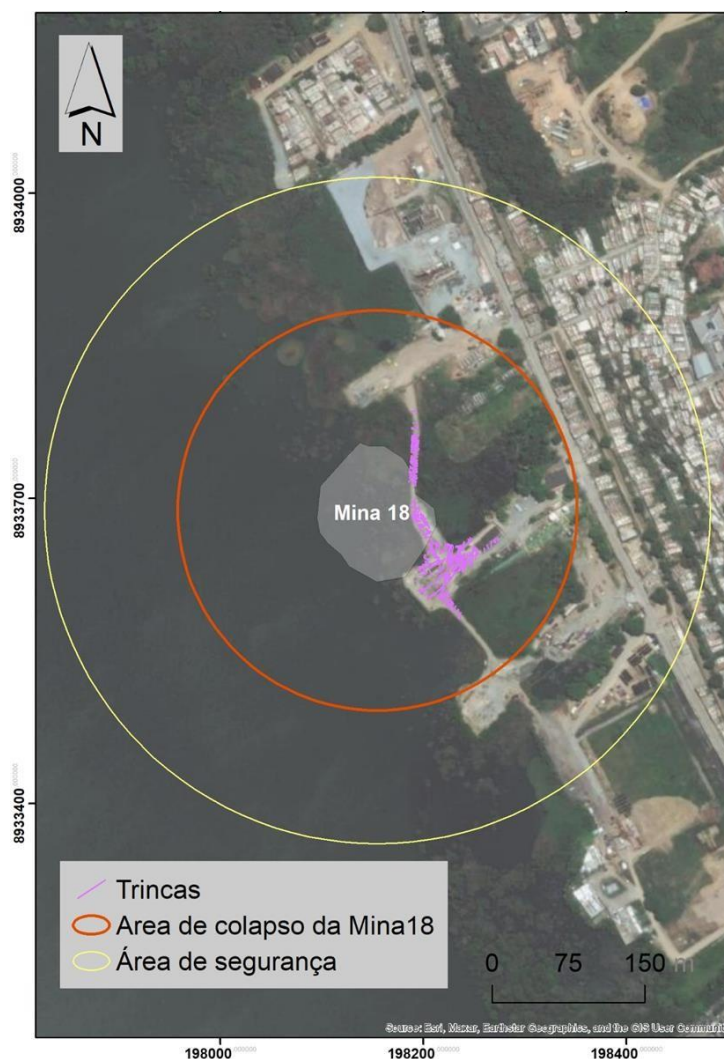
Figura 10 - Localização dos fissuramentos na superfície, raio de possível colapso da mina 18 e raio de segurança da mina 18.
