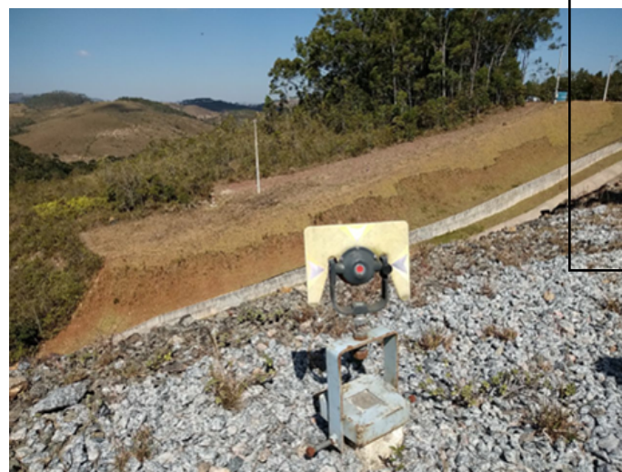
Foto 06: Marco topográfico para monitoramento de deslocamentos verticais e horizontais da Barragem de Rejeitos.
