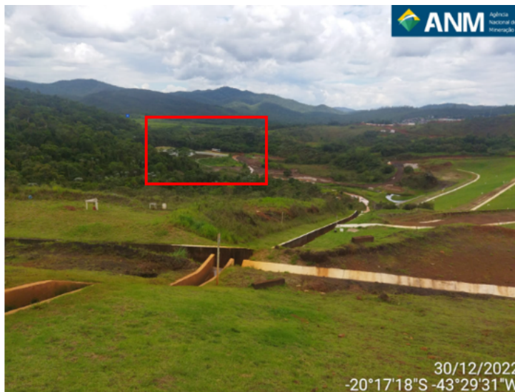
Figura 20 - Destaque em vermelho para a localização do sump , onde a água proveniente do reservatório adquire tempo de residência para decantação dos sedimentos e depois segue o curso natural de água.
