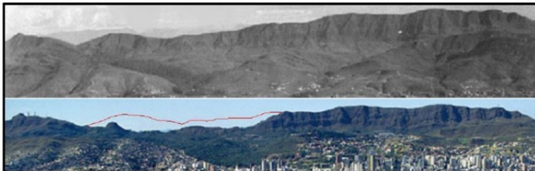
Figura 3 - Comparação dos perfis topográficos da Serra do Curral (1950 e atual) e indicação da área rebaixada pela mineração. Fonte: Bahia, 2015.
