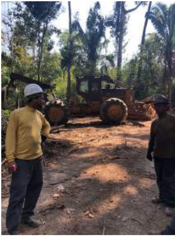
Foto 09 - Trato Skidder utilizado no arraste de toras.
