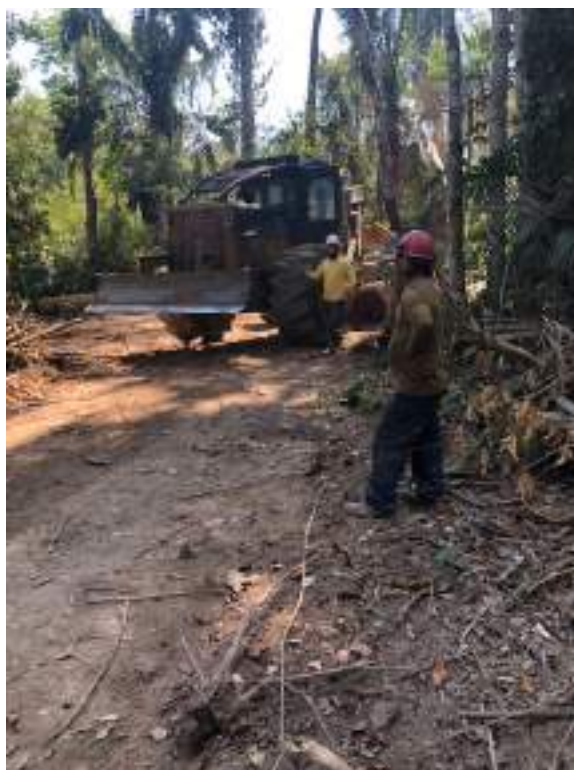
Foto 08 - Trato Skidder utilizado no arraste de toras.
