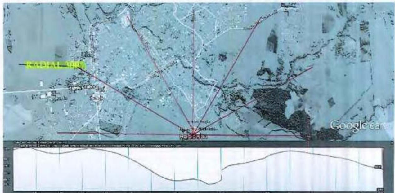
Levantamento de perfil da Radial 300°
