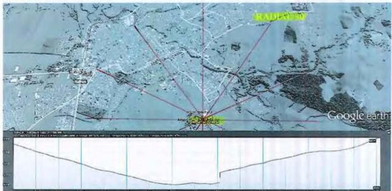
Levantamento de perfil da Radial 30°
