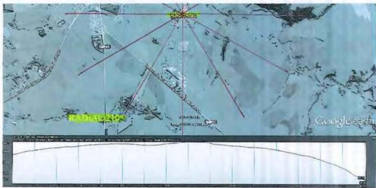
Levantamento de perfil da Radial 210°
