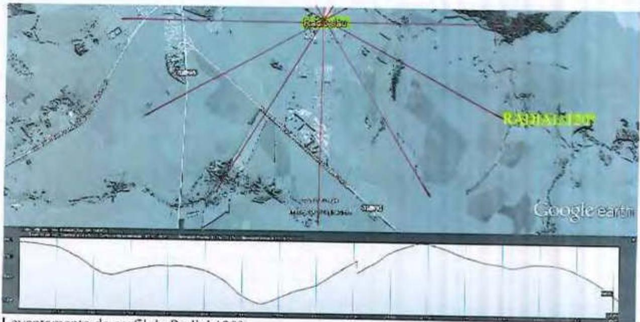
Levantamento de perfil da Radial 120°
