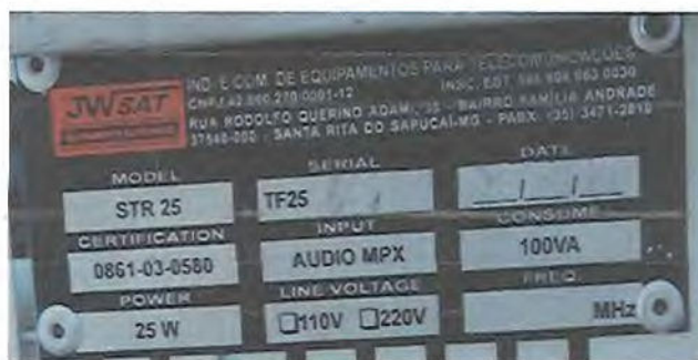
Fig. 6 – Etiqueta de identificação: Fabricante, modelo, número, série e data de fabricação.
