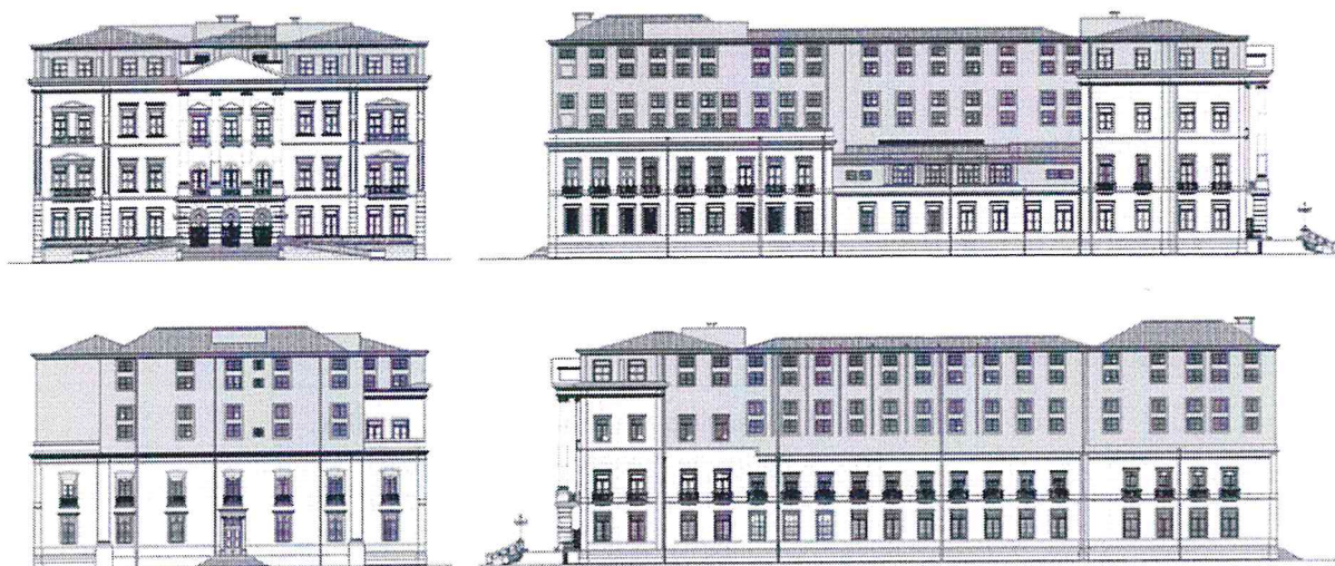
Figura 1 - pavimentos espúrios a serem demolidos destacados com cor nas fachadas, de cima para baixo e da esquerda para direita: Fachada Largo São Francisco de Paula, Fachada Rua do Teatro, Fachada Largo Alexandre Herculano e Fachada Rua Luís de Camões.
