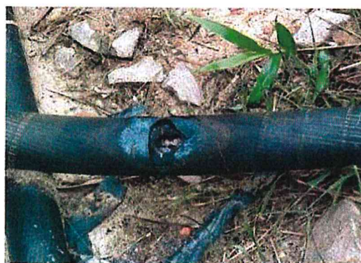
Fig 2: Local da tentativa do furto (rompimento do isolamento)
