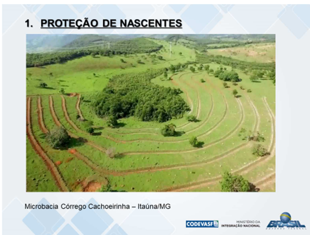
Figura 32: Proteção de nascentes e construção de terraços e barraginhas.
