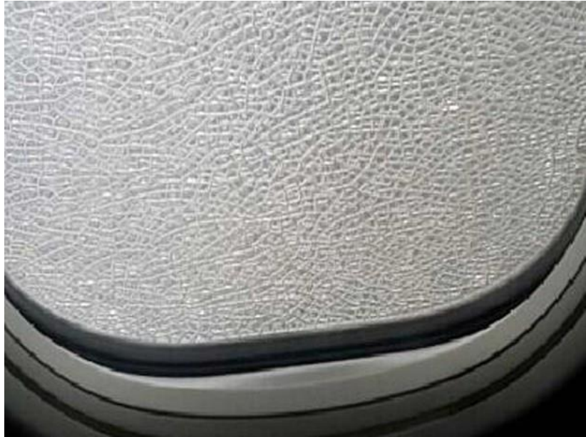
Janela de avião da Gol estilhaçada por calor de turbina que pegou fogo em Brasília (Foto: Arseni Lázaro Facundes/Arquivo Pessoal)
