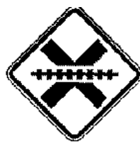
A-39 Passagem de nível 5cm barreira
