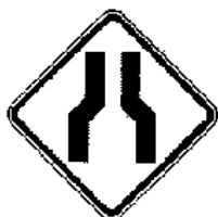
A-21a Estreitamente de pista ao centro
