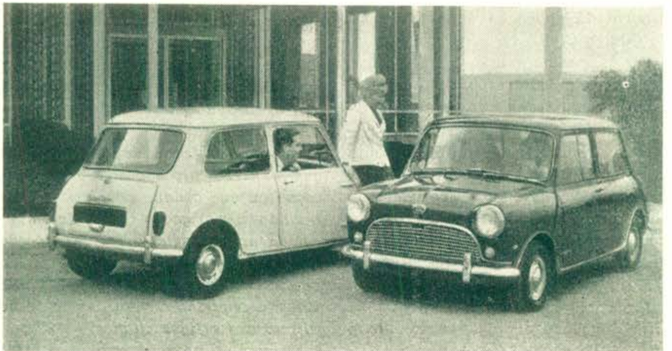
Dois carros da British Motor Corporation: Austin 850 e Morris 850. São êles mecânicamente idênticos, com motor de quatro cilindros e velocidade de 74 milhas por hora. Vai de 0-60 m.p.h. em 26,5 segundos. Consumo de gasolina é de 40/50 m.p.g.
