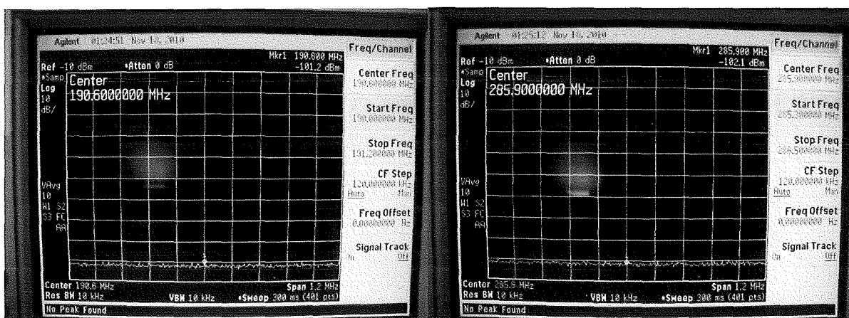
Figura 16 – Espectro de Freqüência – 2º e 3º Harmônicos do Transmissor reserva MTA Eletrônica Industrial – FM 10000
