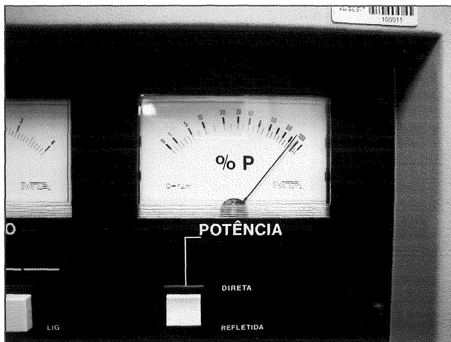
Figura 11 – Leitura de potência direta do Wattímetro THRULINE do Transmissor reserva MTA Eletrônica Industrial – FM 10000
