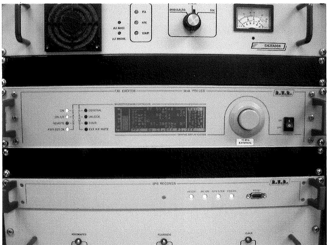
**Detalhe do transmissor – Telavo RDFM 10000A com excitador marca RVR PTX100-LCD**
