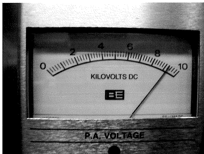
Figura 2 – Leitura do Medidor da Tensão de Placa do Transmissor de FM BE – FM30
