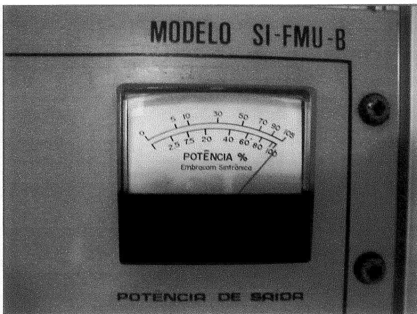
Figura 32 – Medidor de Potência – 1000 Watts
