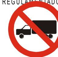
R - 9 PROIBIDO TRÂNSITO DE CAMINHÕES
