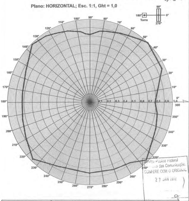
Resp.Téc: Eng:Rogerio Correa OBS: O diagrama acima é para a antena livre de qualquer obstáculo a 5,0 metros montada em uma torre de 0,5m de diâmetro.
