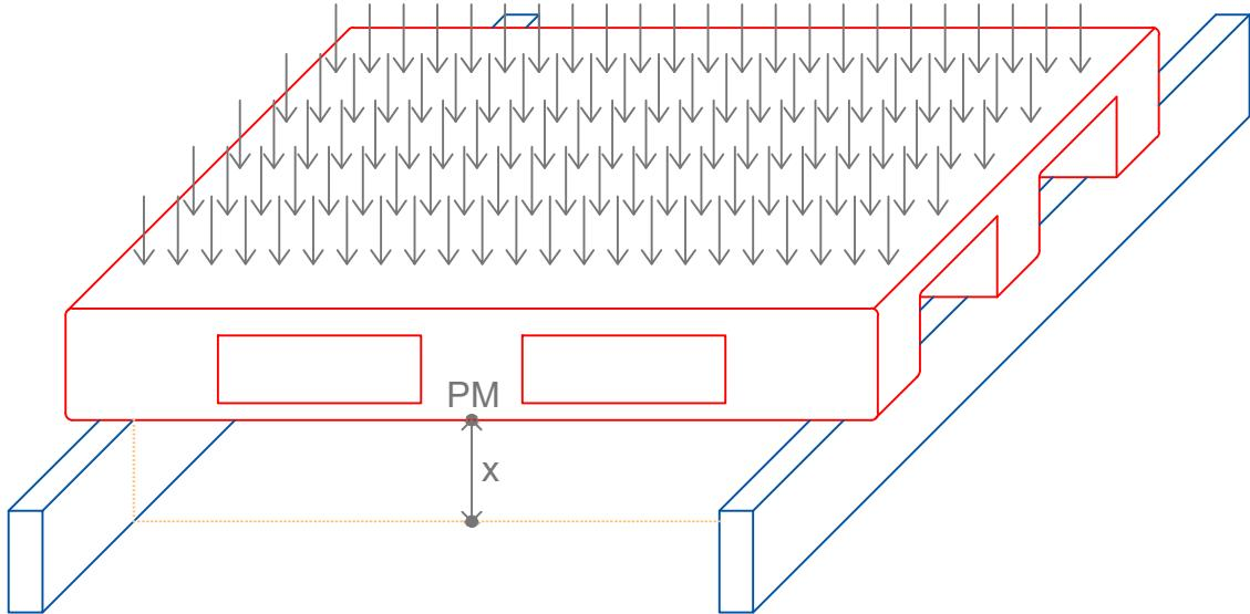
PM - Ponto de Medição da flecha de flexão
