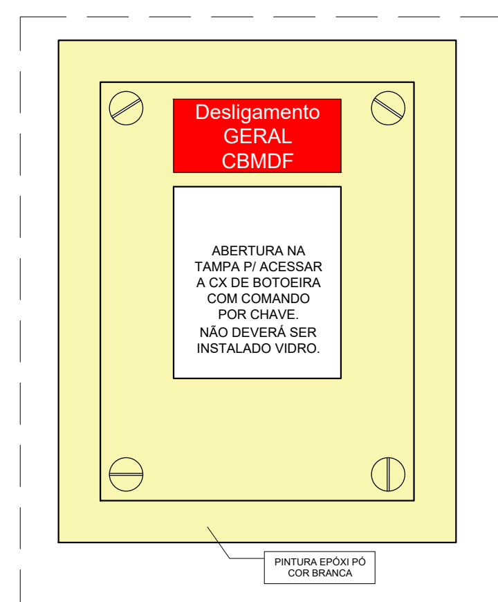
DETALHE SUGESTIVO P/ REVITALIZAÇÃO DA TAMPA DA CAIXA EXISTENTE DE DESLIGAMENTO REMOTO PELO CBMDF NA PORTARIA DO DEMED. ESCALA 1:25
